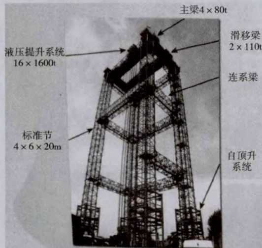
图1 6400吨液压复式起重机
