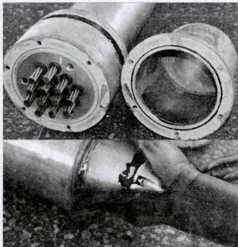
图6 浸泡97小时后解剖系杆锚具内部没有进水
