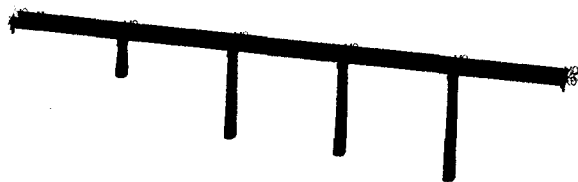
图2 保山岸引桥有限元模型
