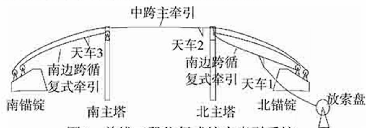
图5 单线三段往复式接力牵引系统
