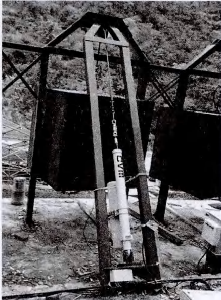
图2 促动器动载试验
